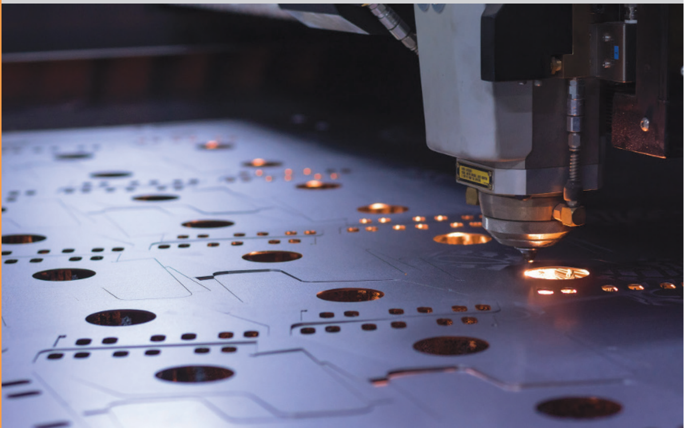
Figura 5.14 Tăierea unui metal cu un fascicul laser
